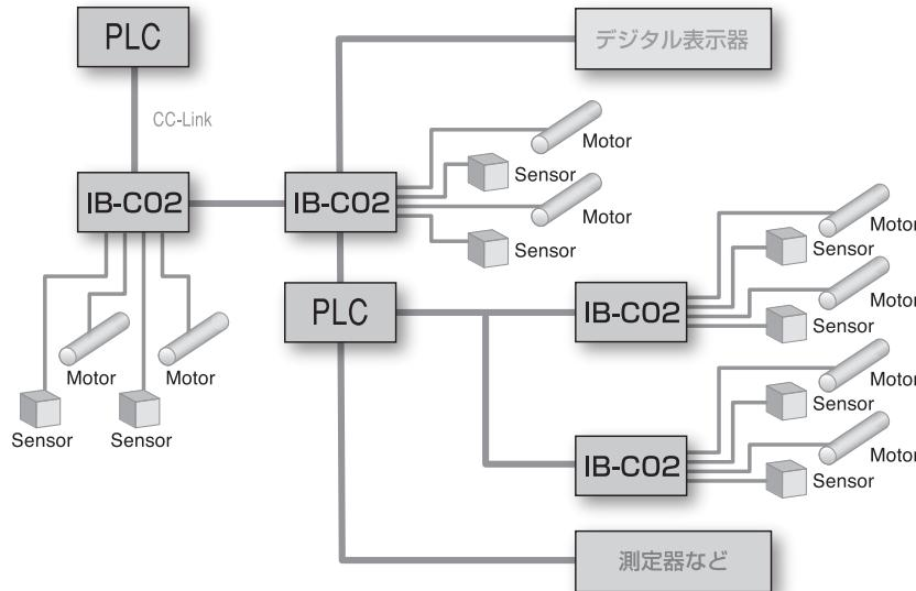
CC-Linkとは、日本・アジア初、制御と情報を同時に扱えるオープン・フィールドネットワークです。日本国内で多く採用されているCC-Link制御機器との接続が簡単に行なえ、ネットワーク範囲が広がります。
