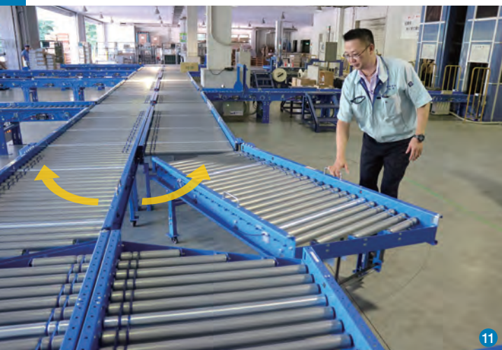
⑪スイングコンベヤは手動で簡単に開く ⑫開口部を走行するフォークリフト
