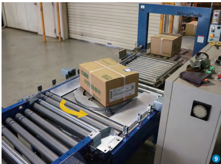
⑦搬送物を仕分けするコンベヤ ⑧バーコード読み取りゲート ⑨ターンコンベヤでの180度反転 ⑩トラックへの積み込み
