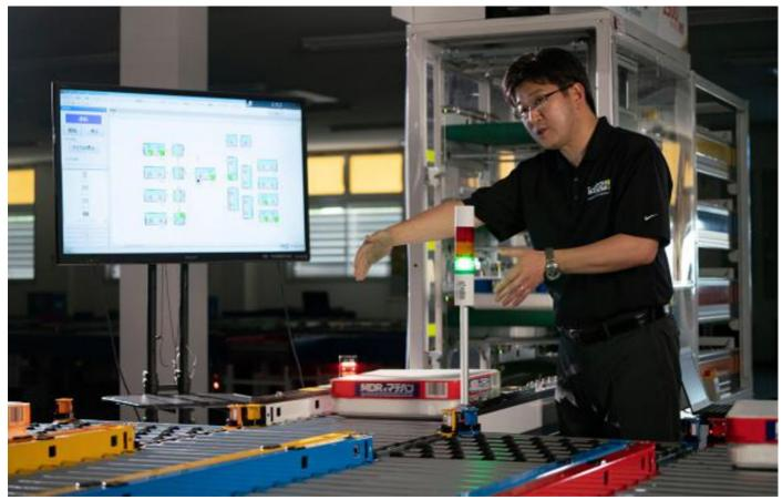
伊東電機の伊東徹弥社長は、コンベヤの設計、設置、メンテナンスにかかる時間を大幅に節約する革新的な id-PAC 物流自動化プラットフォームについて説明する。
