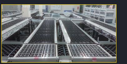
・独自開発の衝撃吸収ローラ「フレキシブル・ノイズレス・ローラ」と小物・袋物対応の仕分け装置「フレキシブル・ノイズレス・ソーター」モジュールを組み合わせ、方面別仕分けを効率アップさせる為の予備仕分けを実現！
