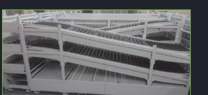
・上りと下りのエスカレータになる傾斜コンベヤと直角分岐モジュール「F-RAT」を組み合わせることで、搬送しながらコンテナの並び替えおよび入出庫作業を同時に実現！
