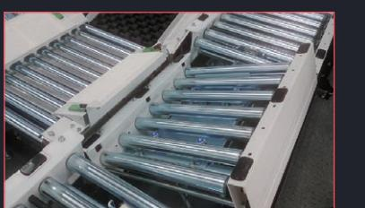
・コンテナからの商品取り出しを改善する「コンテナ傾けモジュール」と商品投入を自動化できる「ショックレス商品取り出しモジュール」で運びながら商品を連続して取り出し！
