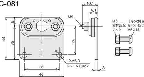
・パワーモータ取付軸の固定は3.0Nm、金具の固定は3.5Nmで締めつけてください。
