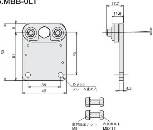
• パワーモータの取付軸の固定は3Nm、金具の固定は3.5Nmで締めつけてください。
