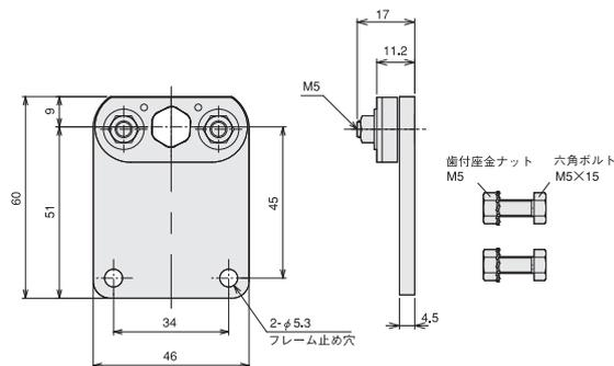
• パワーモータの取付軸の固定は6~10Nm、金具の固定は3.5Nmで締めつけてください。
