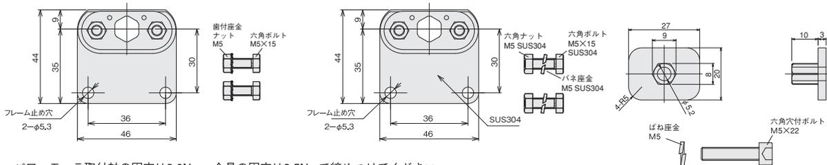
・パワーモータ取付軸の固定は3.0Nm、金具の固定は3.5Nmで締めつけてください。
