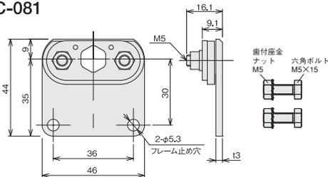
・パワーモータ取付軸の固定は3.0Nm、金具の固定は3.5Nmで締めつけてください。
