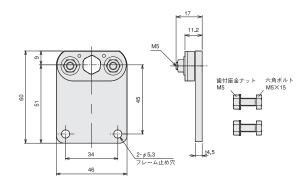
• パワーモーラの取付軸の固定は6~10Nm、金具の固定は3.5Nmで締めつけてください。
