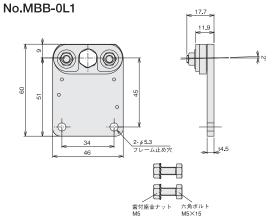
• パワーモーラの取付軸の固定は3Nm、金具の固定は3.5Nmで締めつけてください。
