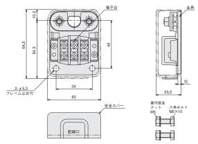
出力軸を確実に固定するため右側のナットから締めつけてください。 パワーモーラの取付軸の固定は6Nm、金具の固定は3.5Nmで締めつけてください。
