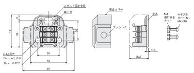
ブッシングは取外し可能です。ビッチ50mmでの取付の際はお取り外しください。 パワーモーラの取付軸の溝にスラスト固定金具をスライドさせ、パワーモーラを固定してください。 スラスト固定金具の固定は0.7Nm。金具の固定は1.7Nmで締めつけてください。
