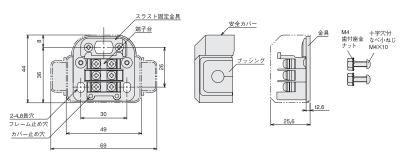
ブッシングは取外し可能です。ピッチ50mmでの取付の際はお取り外しください。 パワーモーラの取付軸の溝にスラスト固定金具をスライドさせ、パワーモーラを固定してください。 スラスト固定金具の固定は0.7Nm。金具の固定は1.7Nmで締めつけてください。 取り付けるフレーム厚は13.8mm以下としてください。
