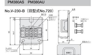
フレーム形状が落とし込みとなる場合にお使いください。 金具の固定は3.5Nmで締めつけてください。
