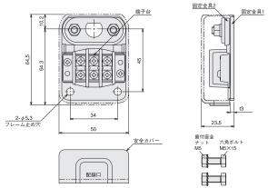
パワーモーラの取付軸の固定は3Nm、金具の固定は3.5Nmで締めつけてください。
