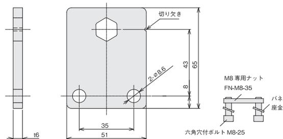
・MBK-0K1はケーブル側の軸、MBK-0K1-7は反対のワンタッチ取付軸機構側の軸に取付けます。
