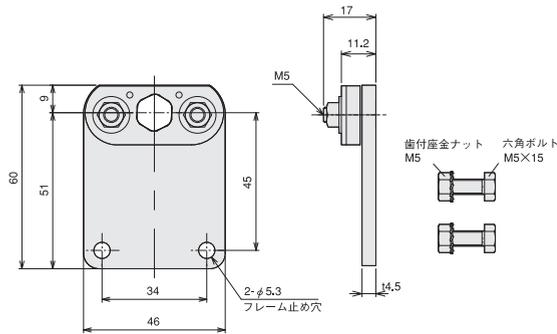
・パワーモラーの取付軸の固定は6~10Nm、金具の固定は3.5Nmで締めつけてください。
