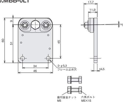
・パワーモラーの取付軸の固定は3Nm、金具の固定は3.5Nmで締めつけてください。
