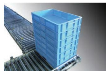
■ 低床機構による段積み品の分岐
