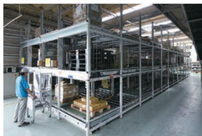
昇降装置と組み合わせた、多段式のパレット並び替え・保管・入出庫自動棚 (商品名:APSS オートパレットシーケンシングシステム)
