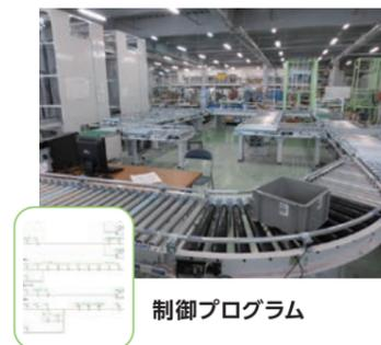
搬送ロジックを搭載したモジュールであるため、プログラム作成が不要です。コンベヤをならべるだけでプログラムが完成します。
