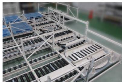
製品のストレージ・出荷順に合わせたパレットの並び替え作業の自動化
