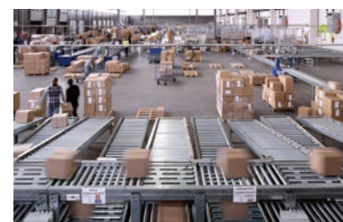
■ スペースを有効活用した多段式ライン
