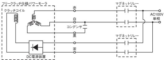
●DC電源装置内蔵型で、モータ電源と同じです。
