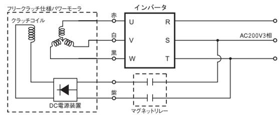
●DC電源装置内蔵型で、モータ電源と同じです。
