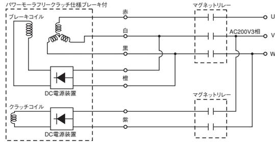
●DC電源装置内蔵型で、モータ電源と同じです。
