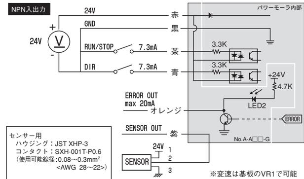
●DIR OFFの時モータケーブル側から見て反時計回り (CCW) に回転します。
