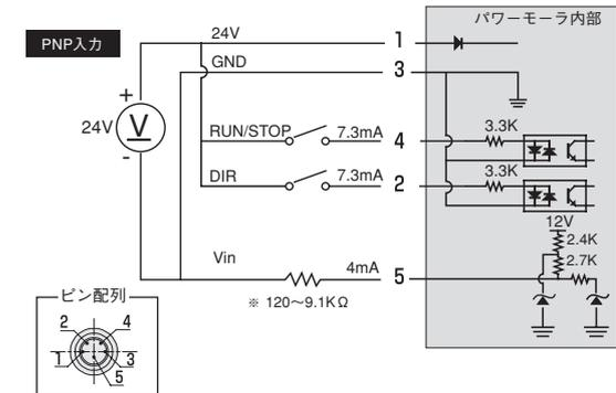
●DIR OFFの時モータケーブル側から見て反時計回り (CCW) に回転します。
