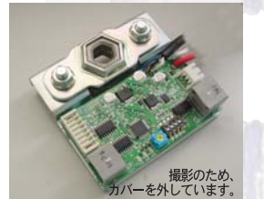
撮影のため、カバーを外しています。 金具にコントロール基板を実装
