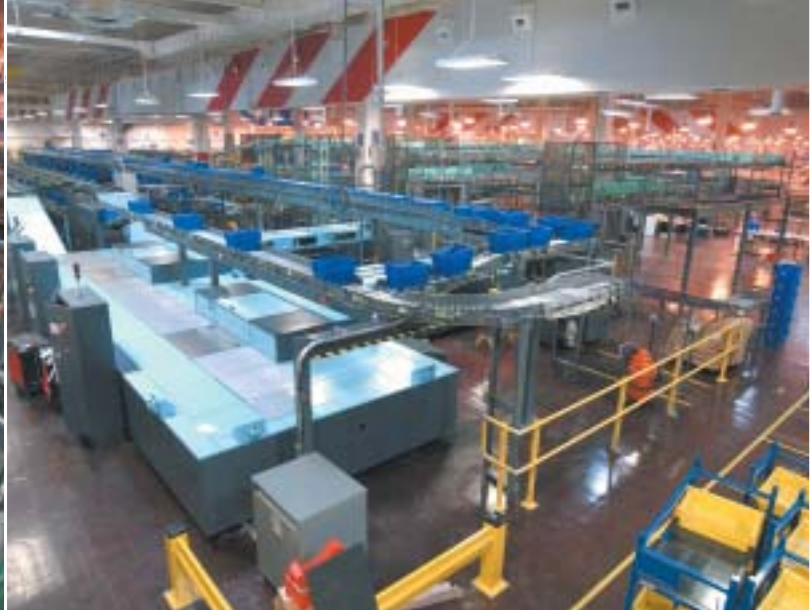
写真 - 1, 2 FSSは1システムに約2,500本のMDR（伊東電機のパワーモータ）を全面採用している（写真は北バージニアのダレス集配局）
