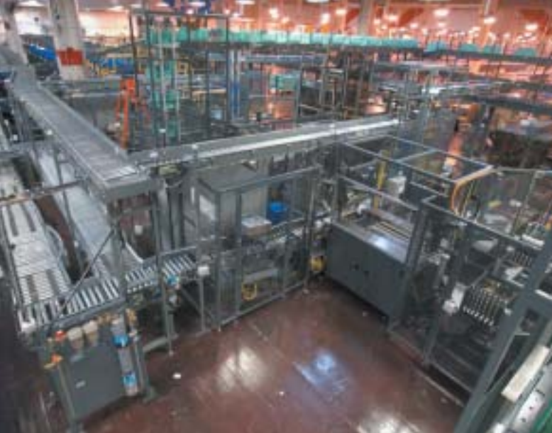
写真 - 1, 2 FSSは1システムに約2,500本のMDR（伊東電機のパワーモータ）を全面採用している（写真は北バージニアのダレス集配局）
